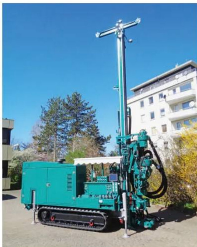
Abb. 5 – Bohrgerät Nordmeyer GeoVario 14
