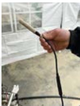
Die Messsonde wird in die Erdwärmesonde eingeführt und überträgt das Signal (Bild links). Ein Blick auf das Display der Überwachungseinheit verrät alle relevanten Daten wie Durchfluss, Signalstärke, das bereits eingebrachte Volumen sowie die Tiefe der Bohrung (Bilder mitte). Die Technik wird dabei stets überwacht (Bild rechts).
