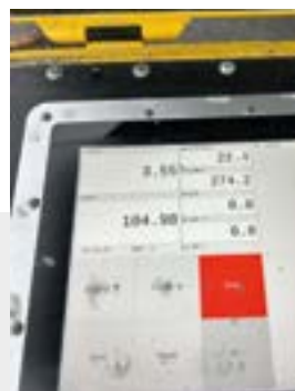
Die Messsonde wird in die Erdwärmesonde eingeführt und überträgt das Signal (Bild links). Ein Blick auf das Display der Überwachungseinheit verrät alle relevanten Daten wie Durchfluss, Signalstärke, das bereits eingebrachte Volumen sowie die Tiefe der Bohrung (Bilder mitte). Die Technik wird dabei stets überwacht (Bild rechts).
