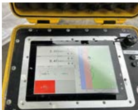
Die Messsonde wird in die Erdwärmesonde eingeführt und überträgt das Signal (Bild links). Ein Blick auf das Display der Überwachungseinheit verrät alle relevanten Daten wie Durchfluss, Signalstärke, das bereits eingebrachte Volumen sowie die Tiefe der Bohrung (Bilder mitte). Die Technik wird dabei stets überwacht (Bild rechts).
