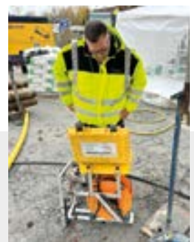
Die Messsonde wird in die Erdwärmesonde eingeführt und überträgt das Signal (Bild links). Ein Blick auf das Display der Überwachungseinheit verrät alle relevanten Daten wie Durchfluss, Signalstärke, das bereits eingebrachte Volumen sowie die Tiefe der Bohrung (Bilder mitte). Die Technik wird dabei stets überwacht (Bild rechts).
